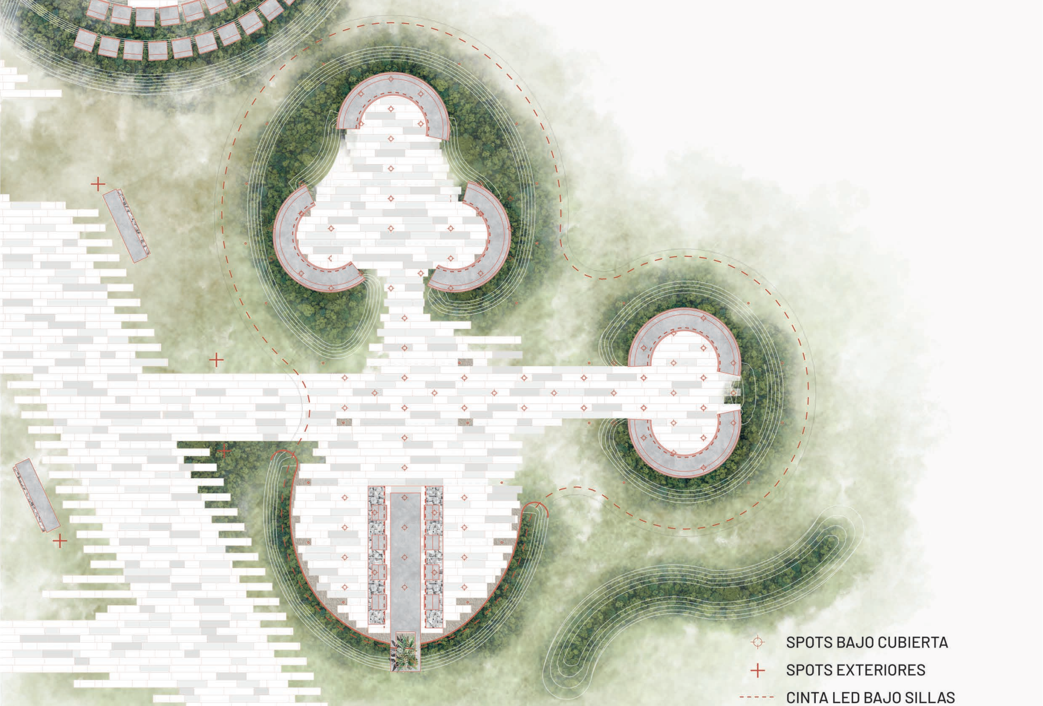
Fig. 101 Distribución de Luminarias - Planta
